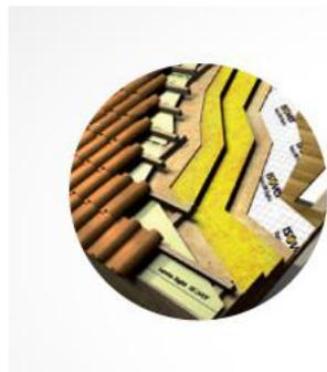
La lana di vetro è la migliore soluzione per isolare sia dal caldo sia dal freddo e permette quindi di minimizzare il fabbisogno energetico dell'edificio in cui è installato: la richiesta di energia termica viene ridotta fino a dieci volte rispetto a un'abitazione standard.
