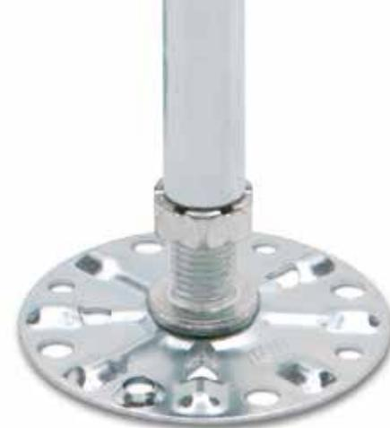
La base, costituita da un disco in acciaio zincato di diametro 90 mm e spessore 1,5 mm, presenta nervature di irrigidimento e nicchie per una migliore adesione della colla alla base e alla soletta di appoggio. Le ulteriori forature presenti consentono eventualmente un agevole fissaggio meccanico. Il sistema di regolazione in altezza, completamente in acciaio zincato, avviene tramite barra filettata M16 e relativo dado dotato di tacche antisvitamento.
