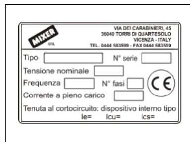
FIG.2 (Targa dati quadro elettrico)
