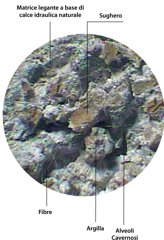
Sezione di Diathonite (ingrandimento del 200%)
