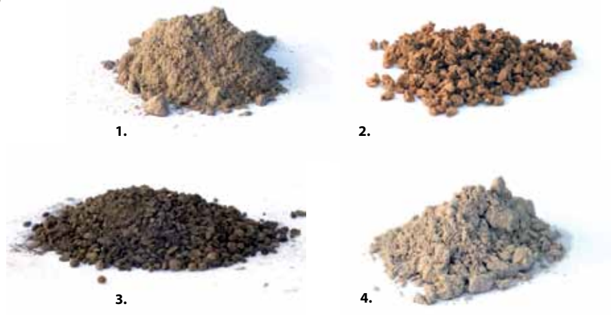
1. Polveri diatomeiche / 2. Sughero / 3. Argilla / 4. Calce idraulica naturale
