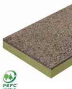
Pannello isolante studiato per l'applicazione a cappotto, costituito da pannello in lana di legno di abete rosso mineralizzata e legata con cemento Portland, spessore 25 mm, accoppiato ad un pannello in lana di roccia monodensità (UNI EN 13162).
