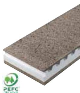
Pannello isolante composto da due strati esterni in lana di legno di abete rosso, mineralizzata e legata con cemento Portland (UNI EN 13168) spessore 50 mm e spessore 15 mm, e da uno strato interno in polistirene espanso sinterizzato (UNI EN 13163) sagomato per la ventilazione.
