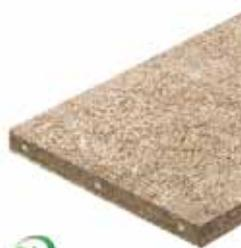
Pannello isolante in lana di legno sottile di abete rosso, mineralizzato e legato con Cemento Portland bianco ad alta resistenza, rinforzato con tre listelli di legno stabilizzato. Conforme alla norma UNI EN 13168. Prodotto selezionato e stabilizzato dall'aspetto pregevole. Larghezza lana di legno: 2 mm. La lana di legno proviene da foreste certificate sostenibili.
