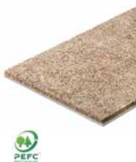
Pannello isolante termico e acustico per controsoffitto a membrana antincendio certificato EI 60, composto da una lastra in lana di legno sottile di abete rosso, mineralizzata e legata con cemento Portland bianco ad alta resistenza (sp. 25 mm), conforme alla norma UNI EN 13168, accoppiato ad una lastra di gesso rivestito del tipo F (sp. 15 mm), conforme alla norma UNI EN 520. La lana di legno proviene da foreste certificate sostenibili.
