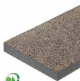
Pannello isolante composto da due strati (sp. 5 mm ciascuno) in lana di legno di abete rosso, mineralizzata e legata con cemento Portland ad alta resistenza e da uno strato interno di polistirene espanso sinterizzato autoestinguente a norma contenente particelle di grafite (UNI EN 13163).
