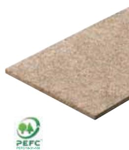
Pannello isolante (Euroclasse A2-s1, d0) in lana di legno extrasottile di abete rosso, mineralizzata e legata con cemento Portland bianco ad alta resistenza, e polvere minerale ad alta densità.
