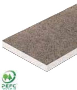
Pannello isolante composto da due strati (sp. 5 mm ciascuno) in lana di legno di abete rosso, mineralizzata e legata con cemento Portland ad alta resistenza e da uno strato interno di polistirene espanso sinterizzato autoestinguente (UNI EN 13163).
