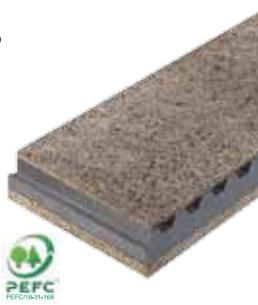
Pannello isolante composto da due strati esterni in lana di legno di abete rosso, mineralizzata e legata con cemento Portland (UNI EN 13168) spessore 50 mm e spessore 15 mm, e da uno strato interno in polistirene espanso sinterizzato con particelle di grafite (UNI EN 13163) sagomato per la ventilazione.
