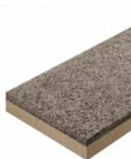
Pannello isolante studiato per l'applicazione in copertura, costituito da pannello in lana di legno di abete rosso mineralizzata e legata con cemento Portland, spessore 50 mm, accoppiato ad un pannello in fibra di legno (UNI EN 13171).
