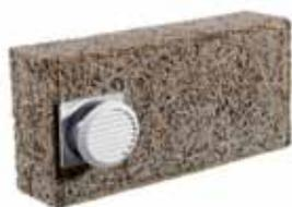
Silenziatore per fori di ventilazione composto da elementi isolanti esterni in lana di legno di abete rosso, mineralizzato e legato con cemento Portland, rivestiti al loro interno con materiale isolante fibroso. Il silenziatore viene fornito con due griglie di ventilazione di colore bianco, conforme alla norma UNI EN 7129-2. La lana di legno proviene da foreste certificate sostenibili.
