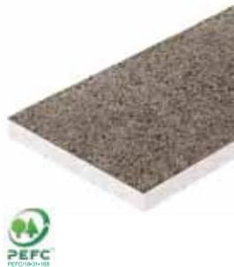
Pannello isolante composto da uno strato (sp. 10 mm) in lana di legno di abete rosso, mineralizzata e legata con cemento Portland ad alta resistenza e da uno strato di polistirene espanso sinterizzato autoestinguente (UNI EN 13163).
