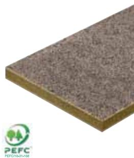
Pannello isolante composto da due strati (sp. 5 mm ciascuno) in lana di legno di abete rosso, mineralizzata e legata con cemento Portland ad alta resistenza e da uno strato interno di lana di roccia a fibra orientata ad alta densità (UNI EN 13162).
