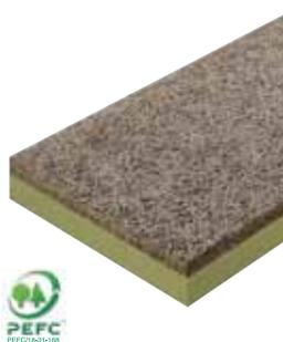
Pannello isolante studiato per l'applicazione in copertura, costituito da pannello in lana di legno di abete rosso mineralizzata e legata con cemento Portland, spessore 50 mm, accoppiato ad un pannello in lana di roccia monodensità (UNI EN 13162).
