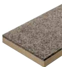
Pannello isolante studiato per l'applicazione a cappotto, costituito da pannello in lana di legno di abete rosso mineralizzata e legata con cemento Portland, spessore 25 mm, accoppiato ad un pannello in fibra di legno (UNI EN 13171).
