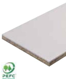
Pannello isolante in lana di legno di abete rosso, mineralizzata e legata con cemento Portland ad alta resistenza, conforme alla norma UNI EN 13168, accoppiato ad una lastra in cartongesso antincendio spessore 12,5 mm. La lana di legno proviene da foreste certificate sostenibili.
