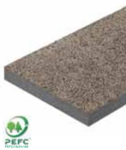
Pannello isolante composto da uno strato (sp. 10 mm) in lana di legno di abete rosso, mineralizzata e legata con cemento Portland ad alta resistenza e da uno strato di polistirene espanso sinterizzato autoestinguente a norma contenente particelle di grafite (UNI EN 13163).
