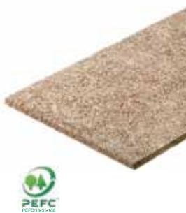
Pannello isolante (Euroclasse A2-s1, d0) in lana di legno sottile di abete rosso, mineralizzata e legata con cemento Portland bianco ad alta resistenza, e polvere minerale ad alta densità.
