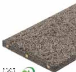
Pannello isolante in lana di legno di abete rosso, mineralizzato e legato con cemento Portland ad alta resistenza, rinforzato con tre listelli di legno stabilizzato. Conforme alla norma UNI EN 13168. Larghezza lana di legno: 3 mm. La lana di legno proviene da foreste certificate sostenibili.
