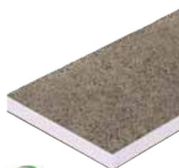
Pannello isolante composto da due strati (sp. 5 mm ciascuno) in lana di legno di abete rosso, mineralizzata e legata con cemento Portland ad alta resistenza e da uno strato interno di polistirene espanso estruso autoestinguente (UNI EN 13164).
